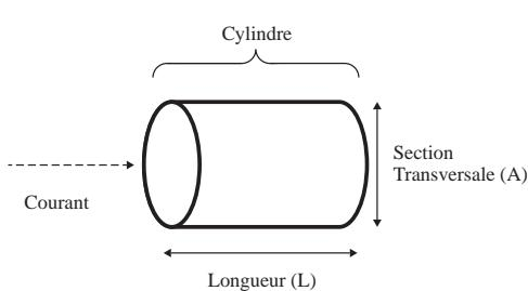
L'impédance est fonction de la résistance et de la réactance d'un segment donné. Ces valeurs dépendent de la longueur et du diamètre d'un segment.
