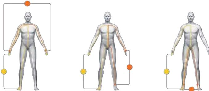
La bio-impédance est l'application du principe de l'impédance au corps humain. Un courant alternatif de faible intensité est envoyé à travers le corps et mesure l'impédance des tissus biologiques. Une fois que l'impédance du corps est mesurée, il est possible d'obtenir l'eau corporelle totale (Equation du Dr Hoffer). Différentes équations sont ensuite utilisées pour déterminer les autres résultats de composition corporelle.
